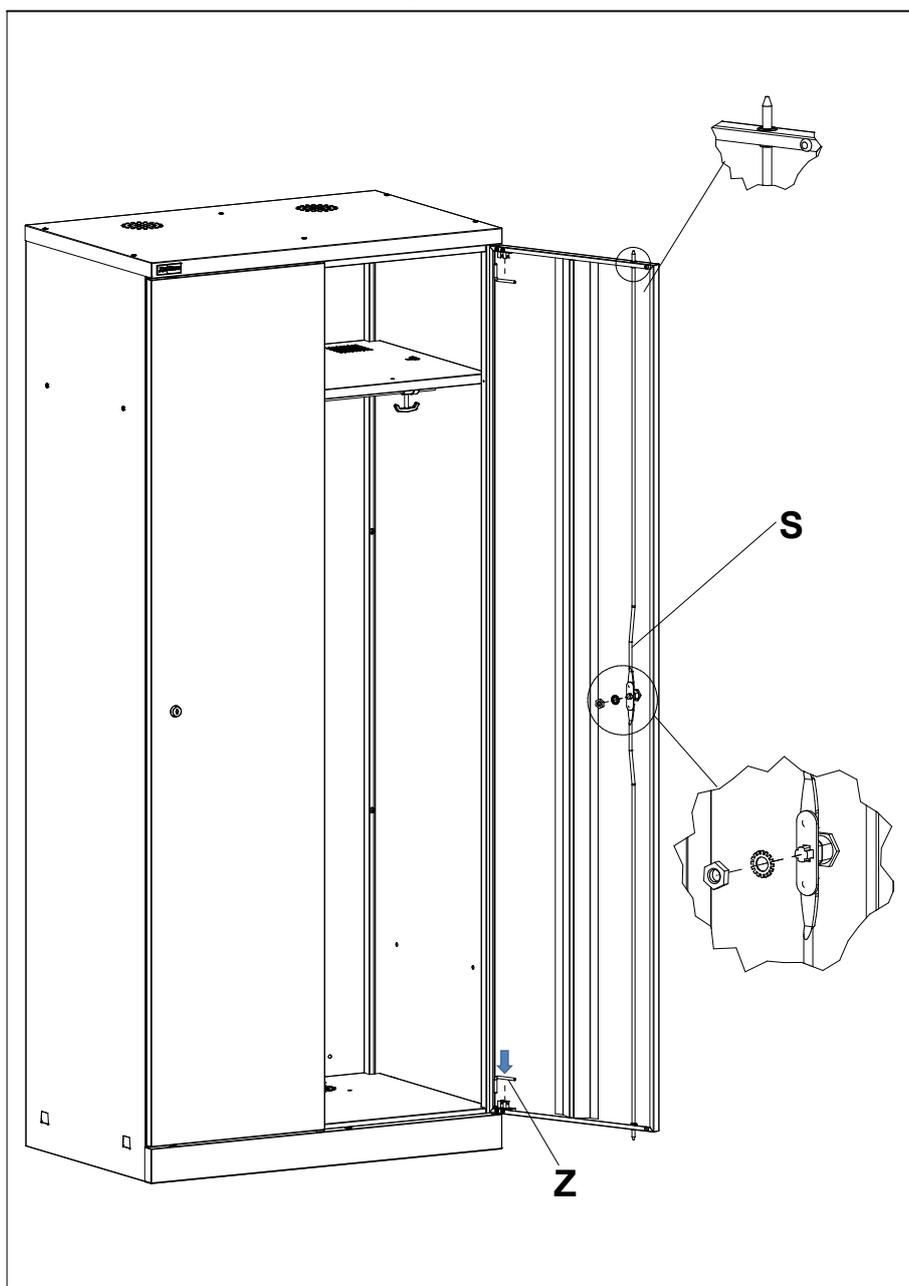
Установить двери в шкаф, защёлкнув оси **Z** в петли пластиковые и вдев их во втулки. Установить тяги **S** на замок. Зафиксировать тяги в положении "закрыто". Тяги должны входить в фиксаторы направляющих.
