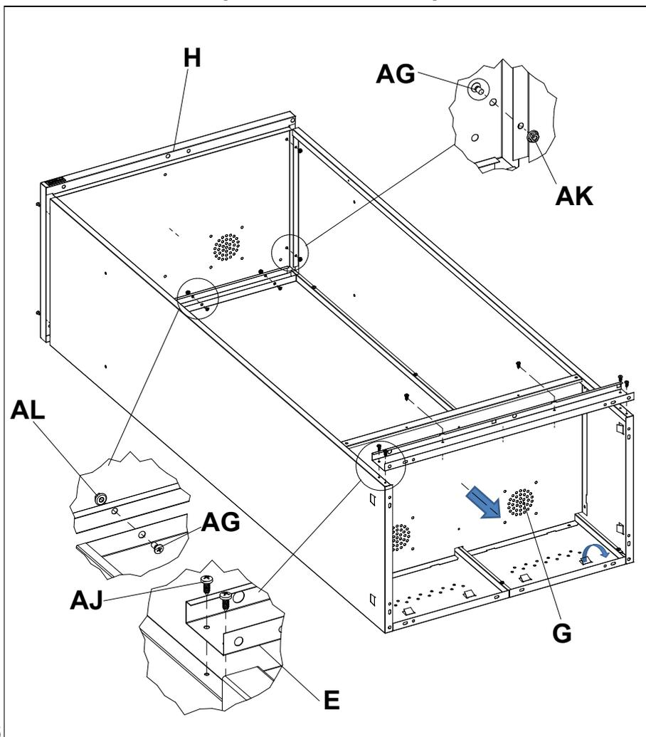
Установить крышку **H** на стенки задние и на стенки боковые при помощи винтов **AG** (M5x10) и гаек **AK**.
