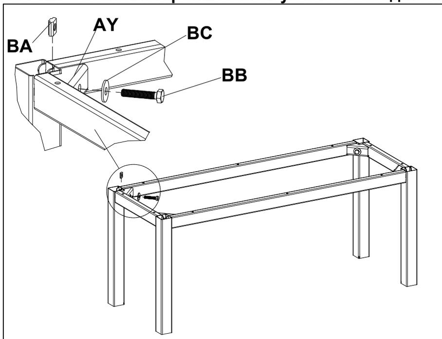
Установить на каркас скамейки кронштейн углового соединения **AY** при помощи болтов **BB** (M8x40), шайб широких **BC** и гаек закладных **BA**.
