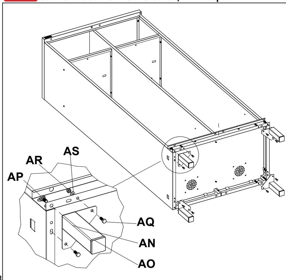
Установить ножки **AN** с заглушками **AO** под шкаф при помощи болтов **AQ** (M6x16), шайб **AS** и гаек самоконтращихся **AR**, а также при помощи болтов **AP** (M8x16).
