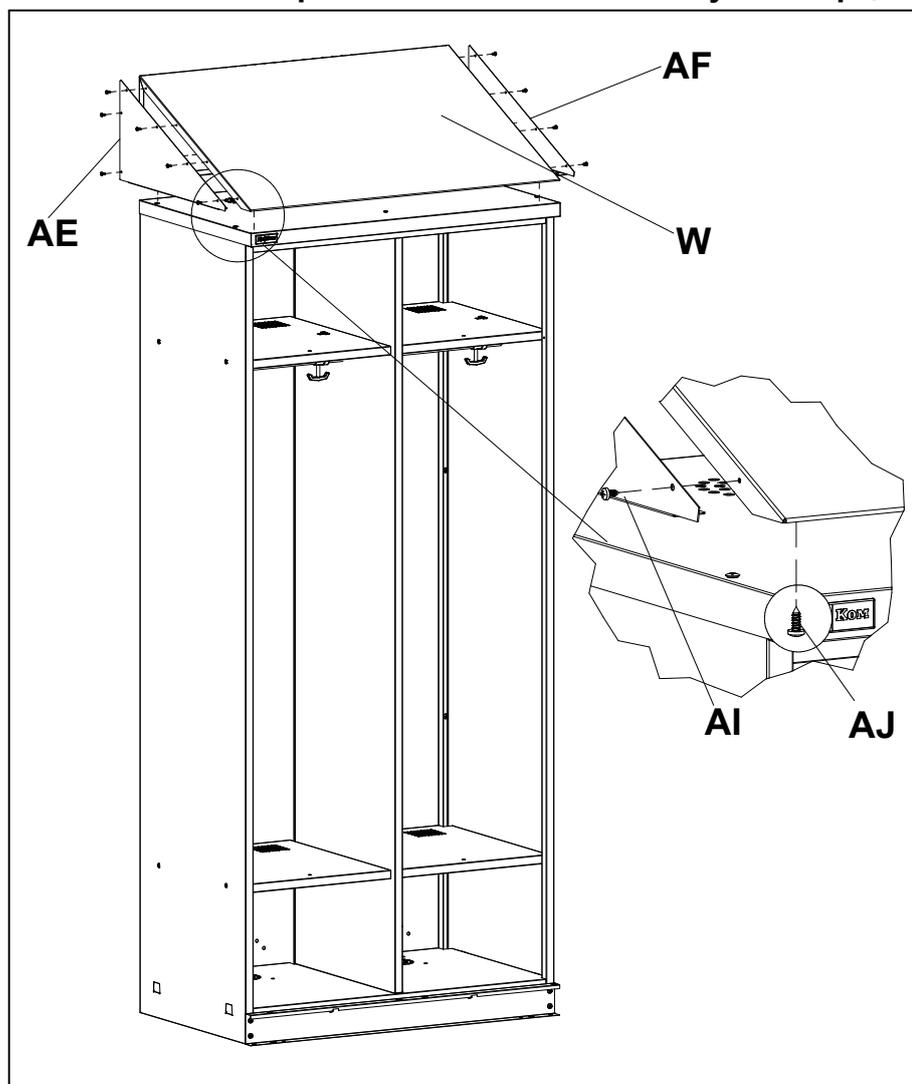
Установить крышку наклонную **W** на крышку шкафа при помощи саморезов **AJ** (5,5x16), **предварительно выбив пукли на крышке шкафа**. Установить боковину левую **AE** и боковину правую **AF** на крышку наклонную при помощи саморезов **AJ** (5,5x16).
