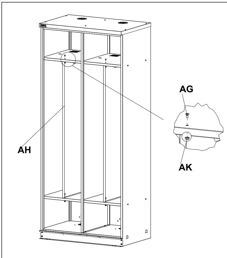
Установить перегородку **AH** или перегородку малую **O** при помощи винтов **AG** (M5x10) и гаек **AK**.
