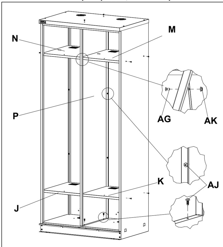
Завести пазы в перегородке **P** под саморезы, установленные в стенках задних. Затянуть саморезы. Установить перегородку на днище при помощи саморезов **AJ** (5,5x16). Установить полки верхние **M** и **N** при помощи винтов **AG** (M5x10) и гаек **AK**. Установить по желанию Покупателя полки нижние **J** и **K** при помощи винтов **AG** (M5x10) и гаек **AK**, предварительно выбив пукли на стенках боковых.
