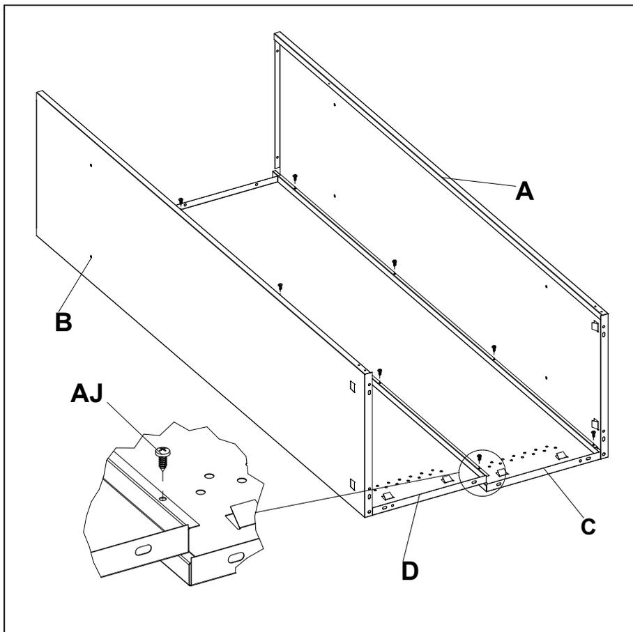
Установить стенку заднюю левую **D** на стенку заднюю правую **C** при помощи саморезов **AJ** (5,5x16).
