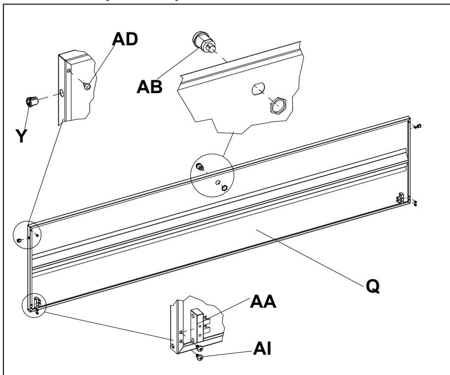
Установить петлю пластиковую **AA** внутрь двери **Q** при помощи саморезов **AI** (4,2x9,5). Установить фиксаторы направляющих **Y**, демпферы **AD** или **AC** и корпус замка **AB**.
